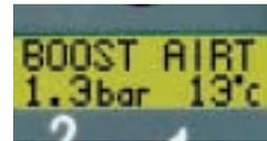
Les 2 entrées analogues sont configurables pour afficher soit une pression (huile, carburant, turbo ou multi-usages) soit une température (huile, eau, différentiel, pont ou multi-usages).
