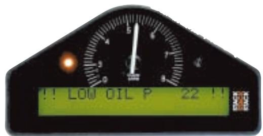
Des alarmes intelligentes sont fournies sur tous les paramètres contrôlés. Les seuils d'alarme sont réglables par le pilote selon les exigences spécifiques du véhicule. Un voyant d'alarme intérieur est monté en standard ; en option, un voyant d'alarme extérieur se branche facilement sur le faisceau du tableau de bord.
